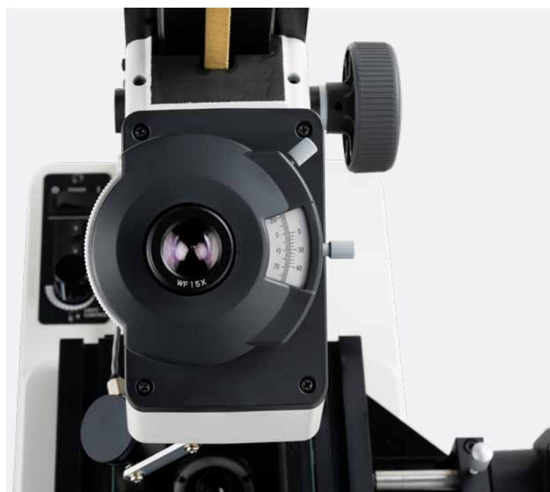
Un goniometro montato all'esterno dell'oculare consente una semplice misura dell'angolo.
