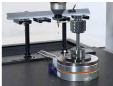
La synchronisation du mouvement de la MMT et de la rotation de la table rotative permet de mesurer rapidement, avec un nombre réduit de positions du palpeur et une précision élevée, des objets qui auraient nécessité de nombreuses positions du palpeur sur une machine conventionnelle. Cette MMT est idéale pour mesurer des pièces en rotation (engrenages, rotors, arbres, roues, disques, cames cylindriques).
