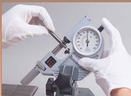
Pour la mesure en série de pièces de révolution symétriques comme les arbres, les axes, etc. ainsi que pour les mesures d'épaisseur et de longueur
