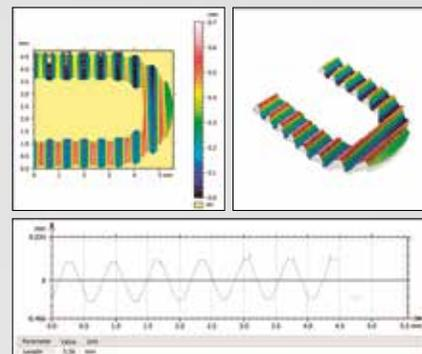
Analisi 3D della forma acquisita mediante PFF e analizzata con MCubeMap
