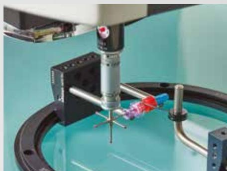
Esempio di misurazione di una valvola utilizzata in apparecchiature medicali
