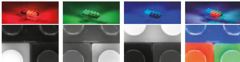
L'utilizzo della funzione di visualizzazione dell'immagine pseudo-colore genera un'immagine di osservazione del colore con un'elevata riproducibilità del colore da ciascuna delle immagini irradiate da RGB.
