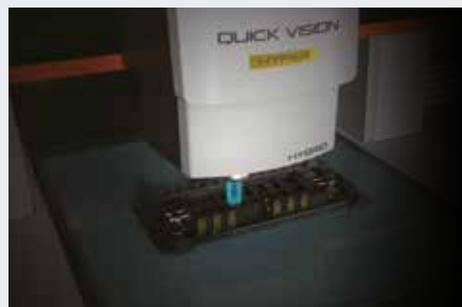
Esempio di misura di una centralina motore
