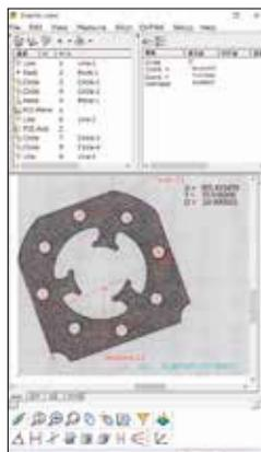
Non solo questa funzione può essere utilizzata per i rapporti sui risultati delle misure, ma è anche possibile eseguire calcoli di alto livello, come calcoli tra elementi e misure PCD, selezionando i diagrammi con il mouse. Inoltre, l'uso efficace della funzione grafica consente di modificare facilmente i part program ed è utile anche per controllare il sistema di coordinate del pezzo corrente e per controllare eventuali misure dimenticate.
