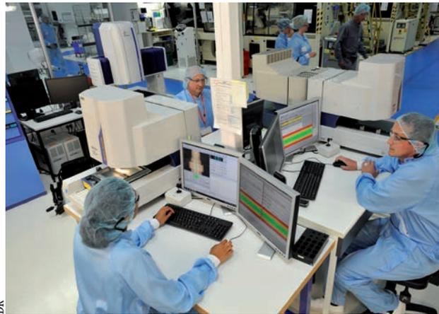
L'espace « Métrologie production » situé au cœur de la ligne de fabrication de l'usine de Nemera, permet, pour chaque lot de pièces fabriqué, de procéder à un cycle de contrôle entièrement automatisé grâce à un programme permettant d'aller chercher toutes les cotes des différents produits.
