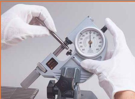
Für die Serienmessung von rotations-symmetrischen Teilen wie Wellen, Achsen usw. als auch für Dicken- und Längenmessungen
