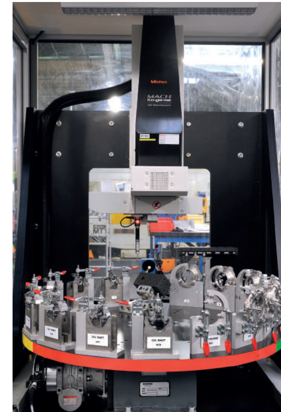
» Système complet comprenant la machine de mesure tridimensionnelle Mach Ko-Ga-Me et le carousel
